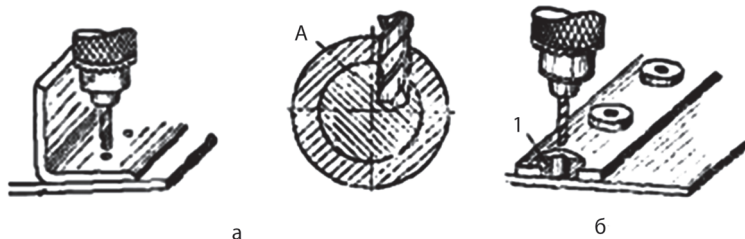
Рис. 5.26. Сверление отверстий по шаблону (а) и по кондуктору (б)
